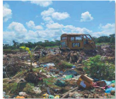
Os resíduos são depositados e espalhados com o auxílio de um trator.
