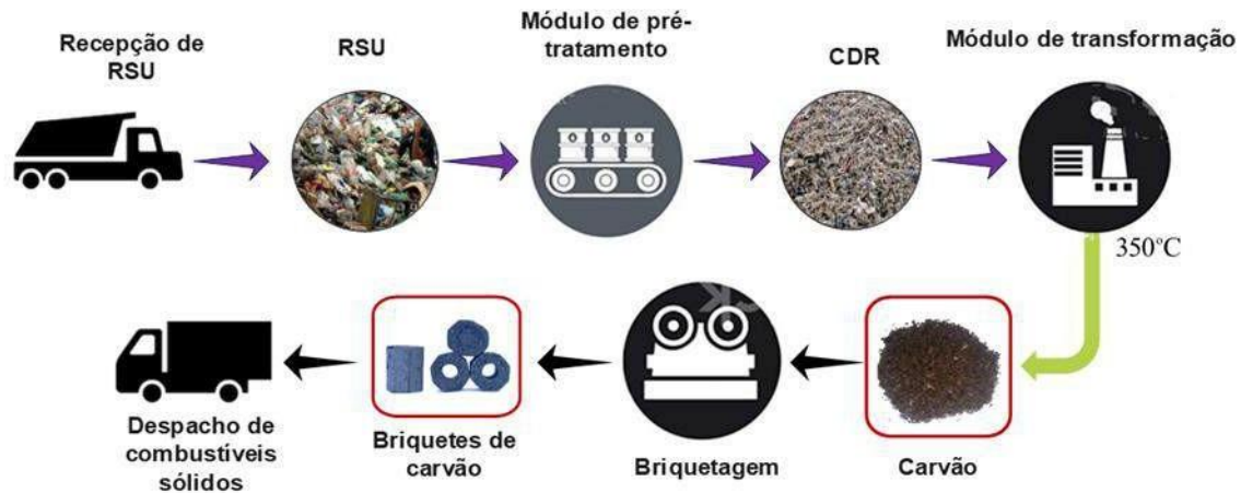
Figura 1. Esquema geral do processo de transformação de RSU em combustível sólido (Fonte: Própria).
